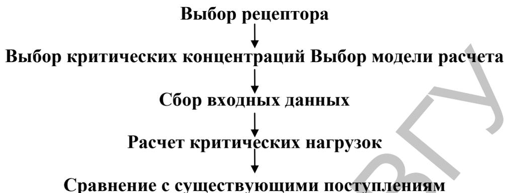
Рис. 1. Схема расчета критических нагрузок при поступлении кислотообразующих и звторфирующих соединений серы и азота в экосистему
