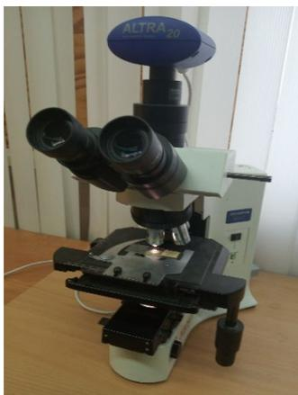
Рис. Мікроскоп OLYMPUS BX 51, оснащений цифровою кольоровою камерою ALTRA 20
