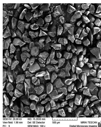
Рис. 1. Поверхностный ориентированный абразивосодержащий слой эластичного инструмента: а – увеличение \times 100 ; б – увеличение \times 200
