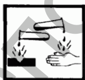
Едкое (коррозионно-опасное) вещество
