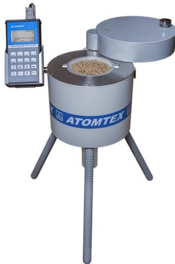
Рис. 4. Внешний вид радиометра РКГ-АТ1320
