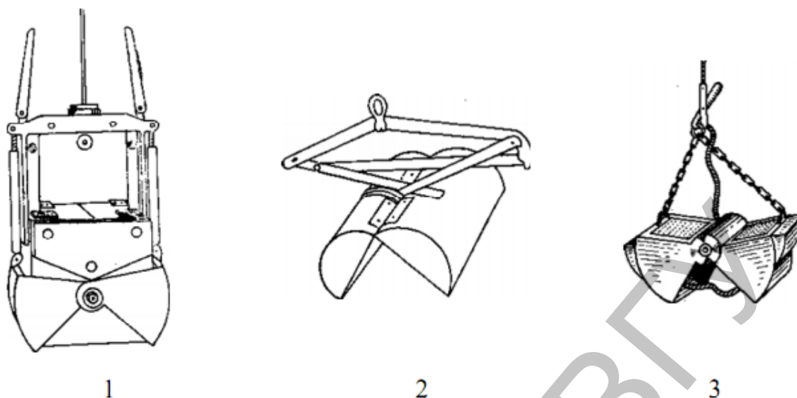
Рис. 2. Гидробиологические орудия. Дночерпатели для количественного сбора бентоса: 1 – Экмана-Берджа. 2 – Петерсена. 3 – Петерсена модифицированный
