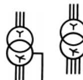
Трансформатор трехфазный трехобмоточный с ферромагнитным магнитопроводом; соединение обмоток звезда с регулированием под нагрузкой - треугольник - звезда с выведенной нейтральной (средней) точкой
