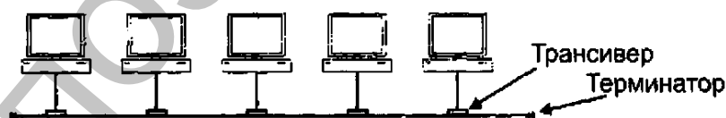
Рис. 6.2.3. Шинная топология сети
