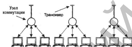
Рис. 6.2.4. Топология «звезда – шина»
