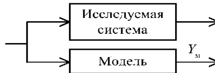
Рис. 13.2.1. Структурная схема экспериментального моделирования
