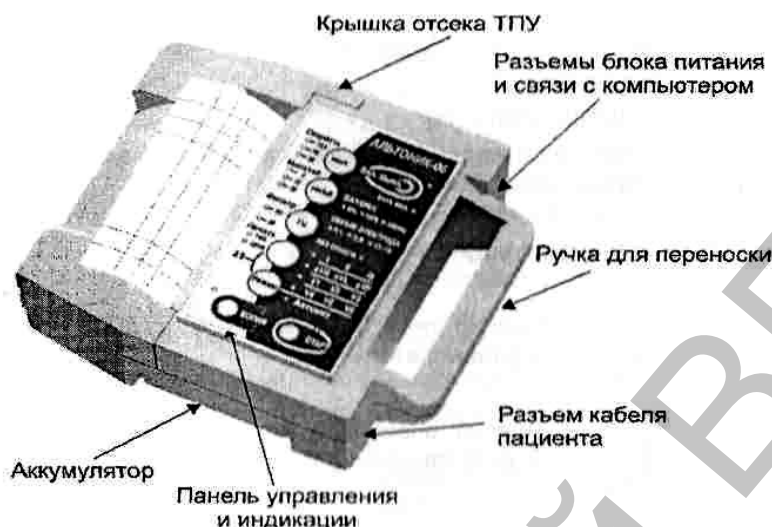
Рис. 5. Внешний вид основного блока электрокардиографа «Альтоник–06».
