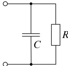
Рисунок 1 – Высокочастотная нагрузка
