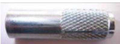
Забиваемый анкер с внутренней резьбой и конусообразным клином, стальной, оцинкованный
