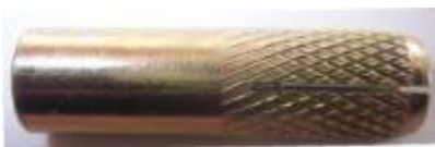
Забиваемый анкер с внутренней резьбой и конусообразным клином, стальной, желтопассированный
