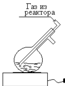
Рис. 1.13. Схема прибора для упаривания в атмосфере углекислого газа.
