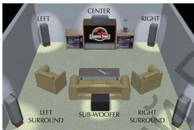
Рис. 5.3.2. Расположение каналов в формате 5.1.
