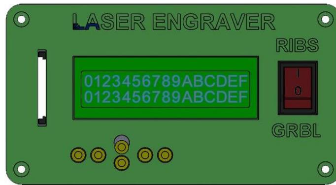
Переключения между системами осуществляется переключением положения на шестиконтактном тумблере, а для возможности подключения к компьютеру выведены порты типа В.
