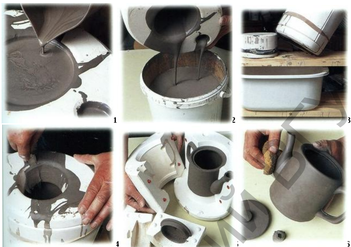
Рисунок 8. Этапы шликерного литья в гипсовой форме
