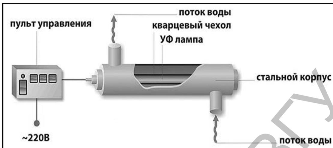
Рис. 3.8. Установка ультрафиолетового обеззараживания воды
