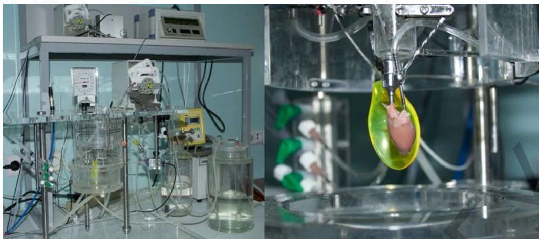
Рис. 11.15. Установка для перфузии изолированного сердца мелких лабораторных животных.
