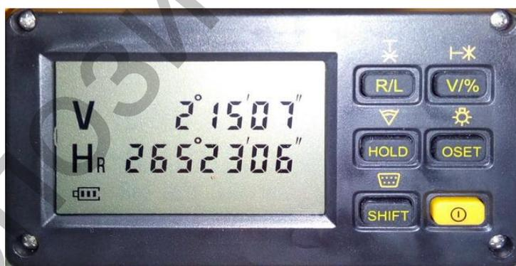
Рис. 4. Дисплей и функциональные клавиши теодолита VEGA TEO-20B.
