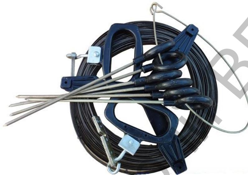
Рис. 21. Мерная лента с железными шпильками.
